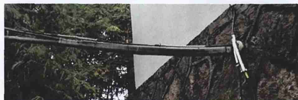
图12: FRP铠装试验光缆放置示意图
