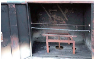
图14: 光缆耐火试验前图
