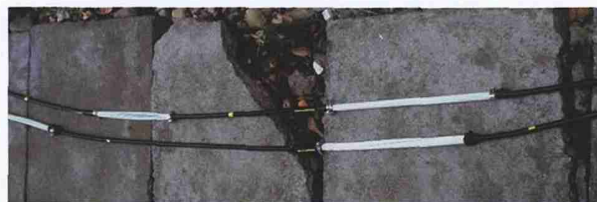
图11: FRP铠装试验光缆
